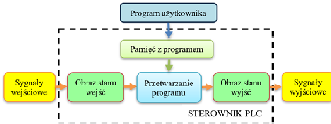
Rys. 1. Zasada działania sterownika PLC
