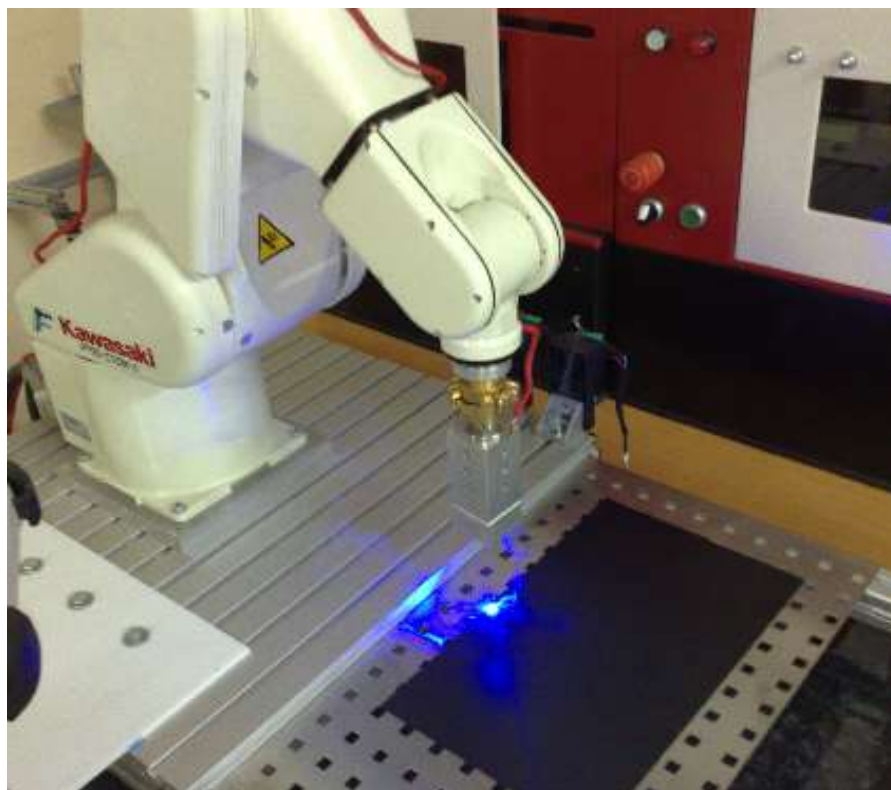
Rys. 7. Robot podczas cięcia laserem edukacyjnym
